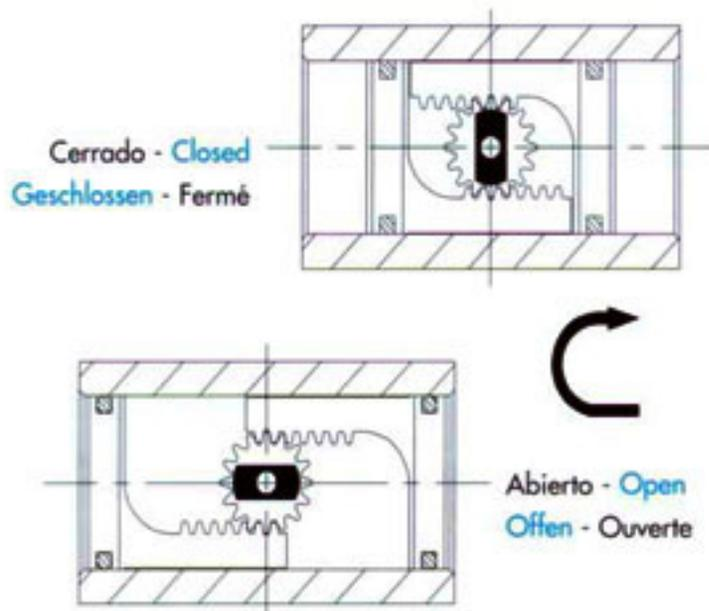
**D** Muelles abren la válvula - 弹簧复位开启阀门
