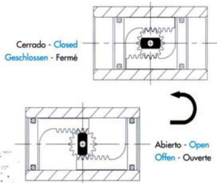
**C** Muelles abren la válvula - 弹簧复位开启阀门
