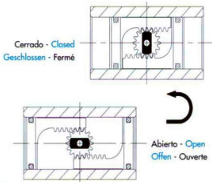
**B** Muelles cierran la válvula - 弹簧复位关闭阀门
